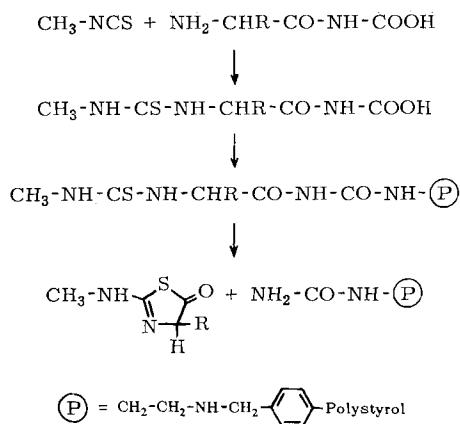
essigsäure zum Thiazolinon cyclisiert. Danach wird die feste Phase abgetrennt und der Abbau wiederholt. Das im Filtrat enthaltene, aus der endständigen Aminosäure gebildete Thiazolinon wird analysiert. Der am Träger verbliebene Peptidrest wird mit HCl zerlegt; die Aminosäuren lassen sich im Hydrolysat bestimmen. / *J. Amer. chem. Soc.* 88, 5345 (1966) / -Ma. [Rd 645]
